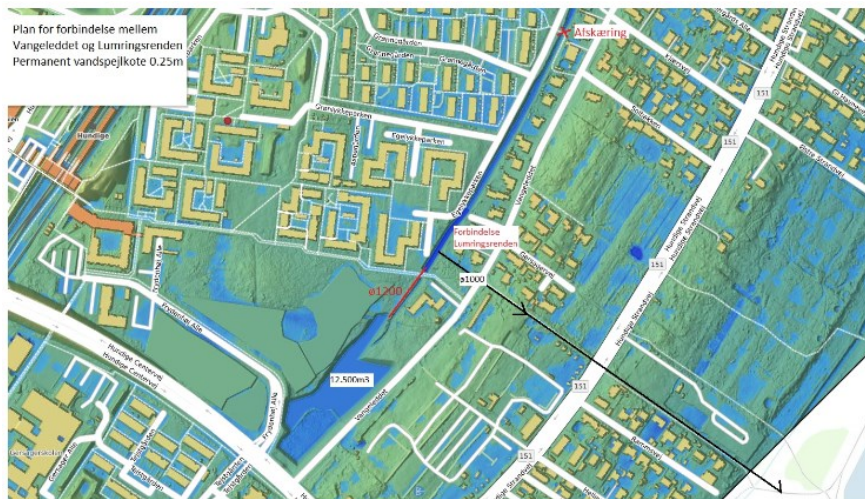
Figur 3: Skitseoplæg til udvidelse af KLAR Forsynings klimatilpasningsprojekt ved udvidelse af bl.a. matr.nr 4b Hundige By, Kildebrønde samt plan for forbindelse mellem Vangeledet bassin og Lumringsrenden med permanent vandspejlskote 0,25 DVR.
