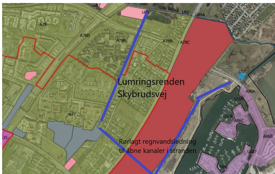
Figur 11: Skitse over regnvandshåndtering for opland A77 herunder Strandby Have (stort gråt område)
