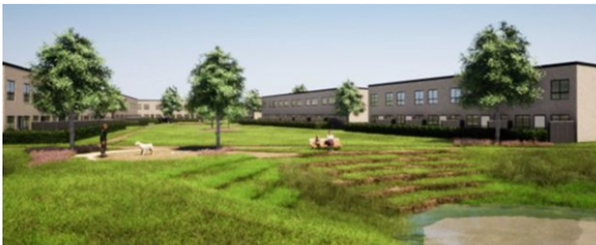
Figur 4: Skitse over regnvandsbassinernes udformning med af stejlehed på 1:5 samt med terrasser for rekreativ anvendelse,
