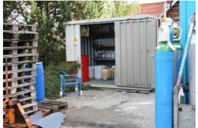
Lille container med indrettet spildbakke til udendørs opbevaring af farligt affald og farlige råvarer og produkter.
