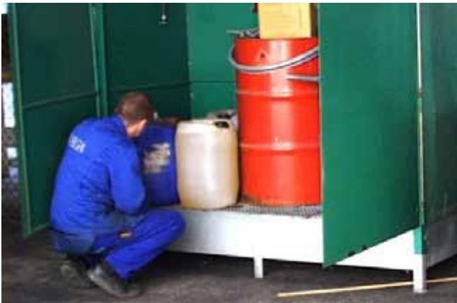
Minicontainer med spildbakke, der kan lukkes, til udendørs opbevaring af farligt affald, råvarer og produkter.
