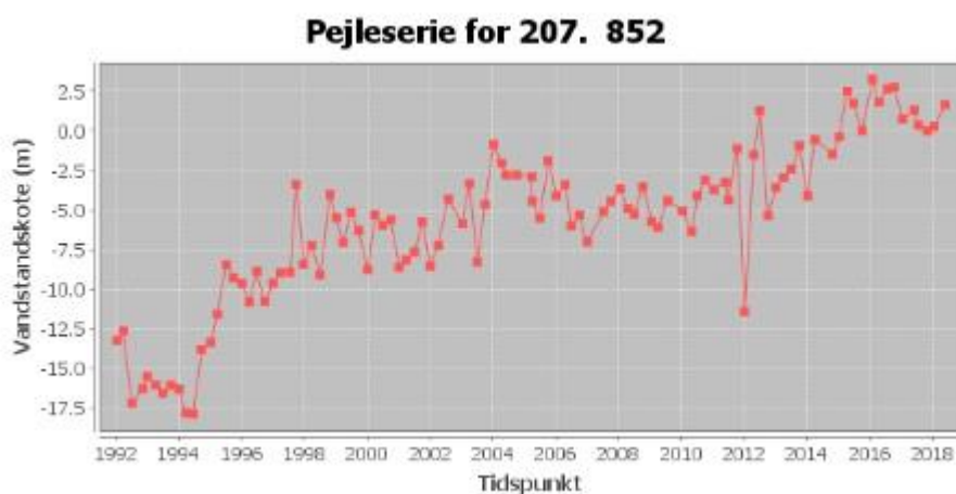
Figur 3-3 Udvikling i grundvandspotentialet i boring 207.852 (B11)
