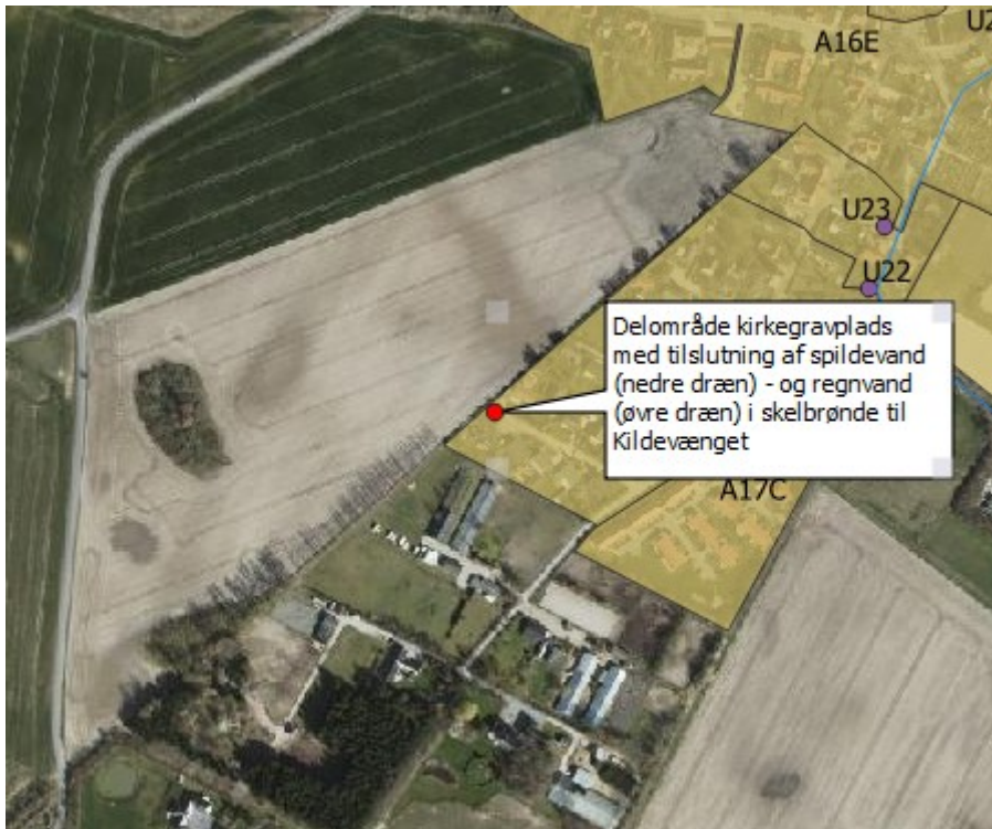
Figur 2: Principskitse over tilslutning af drænvand fra kistegravområdet til henholdsvis spildevands- og regnvandsledning ved Kildevænget
